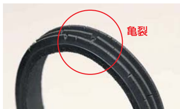
劣化により亀裂が入ったベルト
