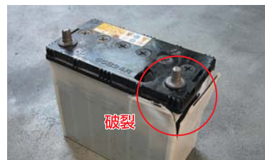
破裂したバッテリー
